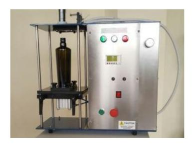
PACKO1 in versione da banco è un tappatore semiautomatico con iniezione azoto,infatti prima del processo di tappatura un microforo inietta azoto per un tempo prestabilito e personalizzabile.
