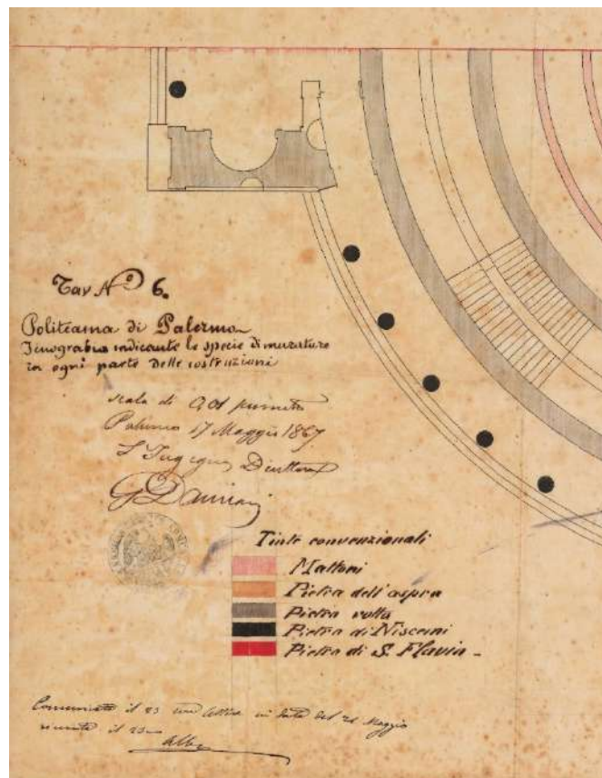
Fig. 4: “D26 - Politeama, pianta con legenda delle tipologie murarie”, s.d. China e acquerello su carta lucida, progetto in scala 1:100 delle diverse murature per il teatro. L’annotazione “scala di 0,01 per metro” è corredata da una legenda delle campiture che differenziano i diversi materiali, come i mattoni per i palchi e i corridoi, la pietra dell’aspra per l’ingresso e scala separate per l’Ubbione (l’ordine) destinato al popolo, e la pietra di Niscemi per il colonnato.
