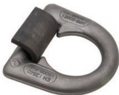
art. 45120T16 ANELLO FERMACARICO T. 16 OMOLOGATO C/SUPPORTO A SALDARE EN29367-2 (trasporto per mare)/ EN 12640(trasporto su strada) gr. 2.310
