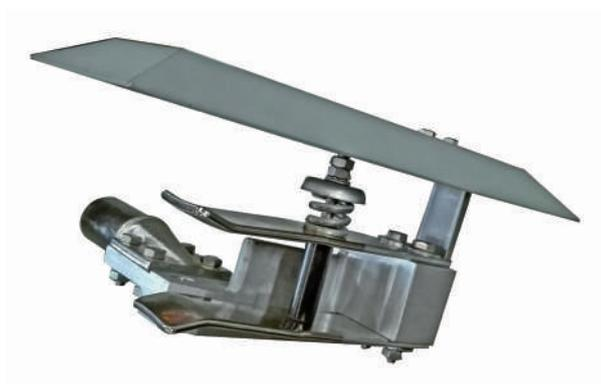
**CONTATTO FISSO** per sezionatore BAGNAGATTI/EMAT tipo ERT3 170 kV 800 A o 1250 A. In rame nichelato stagnato. Completo di molla di pressione in acciaio inox e viteria di fissaggio in acciaio inox.
