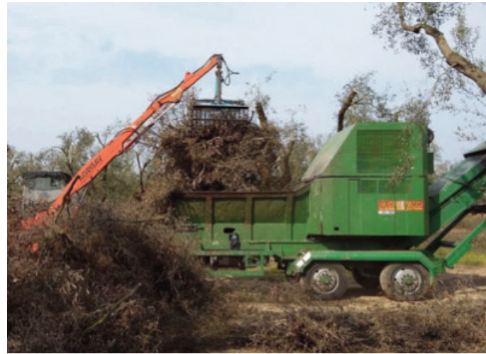
FIGURA 3. Triturazione dei residui di potatura con tritatore mobile (Caravaggi mod. BIO900) per oliveti di grandi dimensioni
