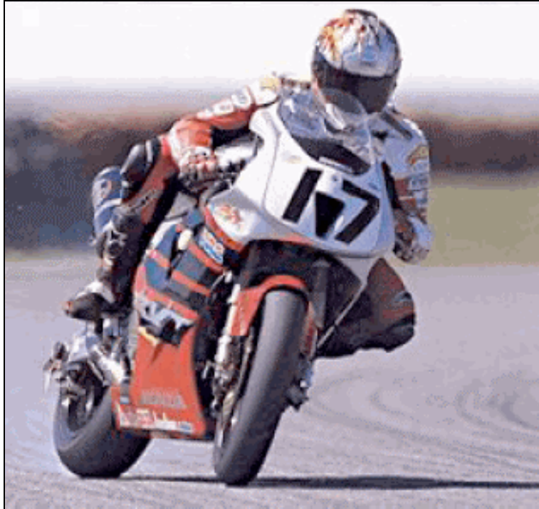
Figura 57 - Recupero della sbandata in controsterzo
