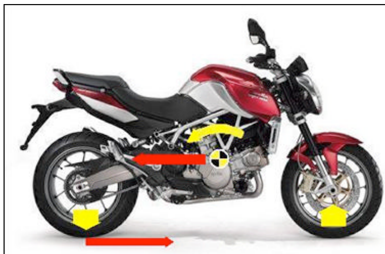
Figura 49 - Trasferimento di carico in accelerazione
