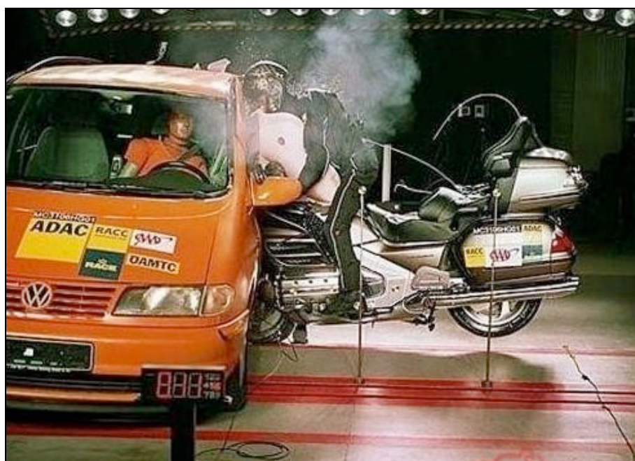
Figura 2 - Crash test dell'Honda Gold Wing con airbag
