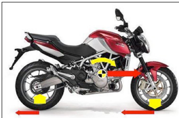
Figura 51 - Trasferimento di carico in frenata
