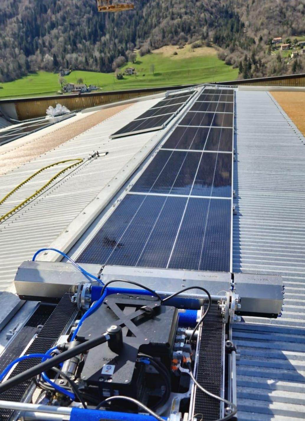
Utilizziamo un sistema di purificazione dell'acqua tramite una pompa di purificazione che assicura un'acqua pura e demineralizzata al 99% prima di essere immessa nel macchinario, garantendo un'elevata pulizia del modulo.
