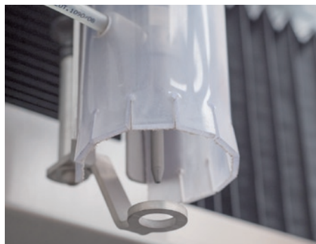
AHC - Automatic Height Control La testa Water Jet è dotata di un sistema di controllo automatico dell'altezza di taglio mediante tastatore meccanico. È possibile definire differenti modalità di controllo della stessa direttamente da controllo numerico. The Water Jet cutting head is equipped with an automatic height control device by mean of mechanical sensor touching the plate periodically and adjusting the height accordingly. The frequency of touch can be selected by the operator from the CNC.
