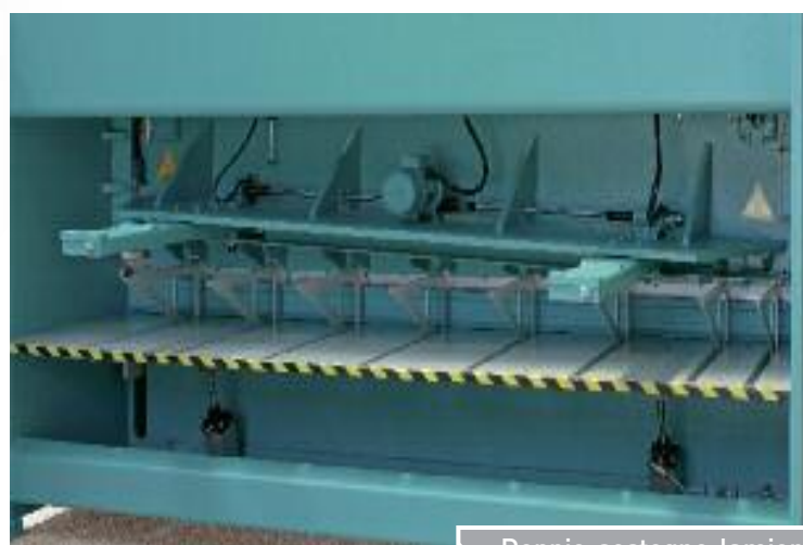
Doppio sostegno lamiera per spessori fino a 6 mm, ruote in teflon per facilitare tagliato.
