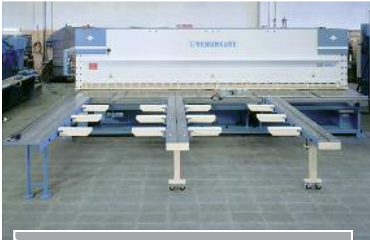
Squadra laterale fissa e due supporti scorrevoli sul fronte macchina con bracci di sostegno retraibili.
