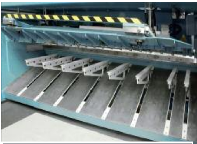
Sostegno lamiera idraulico a doppio movimento rivestito in teflon, sincronizzato con la ghigliottina, dotato di chiusura ermetica dello scivolo per il taglio dei materiali speciali.
