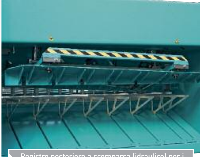
Registro posteriore a scomparsa (idraulico) per i tagli oltre la lunghezza della corsa del registro.
