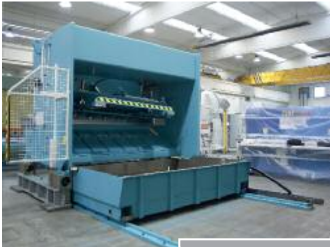
Sistema di evacuazione motorizzato per facilitare la raccolta dei pezzi tagliati.
