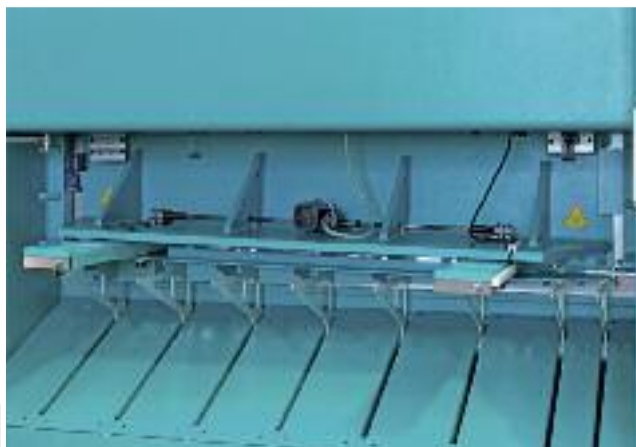
Sostegno lamiera pneumatico per spessori fino a 6mm.
