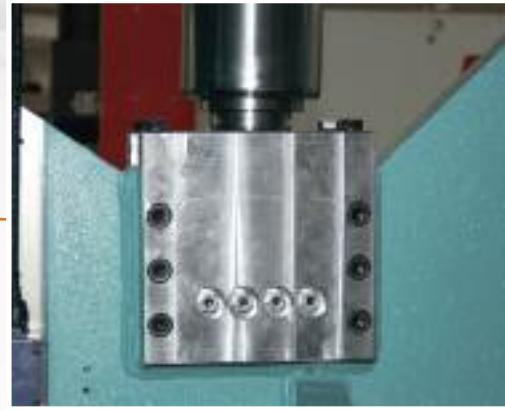
Aggancio della ghigliottina ai cilindri con sistema sferico regolabile, a bagno d'olio.
