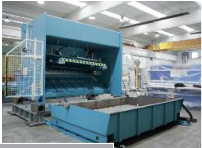
Sistema di evacuazione motorizzato per facilitare la raccolta dei pezzi tagliati.
