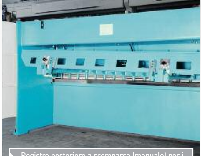
Registro posteriore a scomparsa (manuale) per i tagli oltre la lunghezza della corsa del registro.
