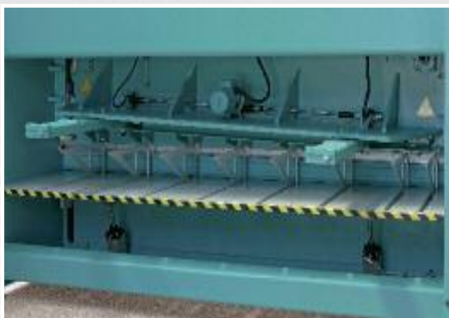
Doppio sostegno lamiera pneumatico (bracci tavolo) per spessori fino a 6mm, con sistema antigraffio per lamiere lucide o protette.
