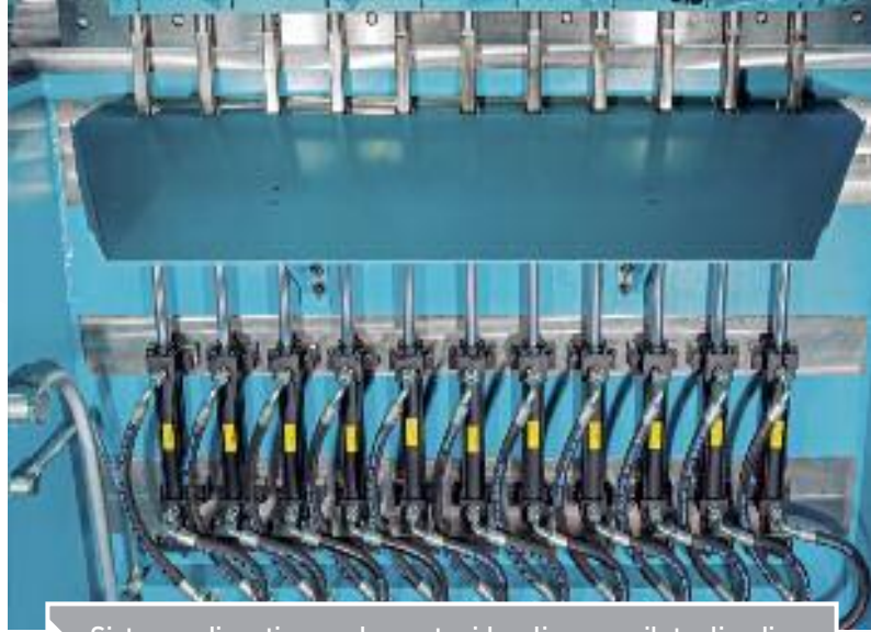
Sistema di antisvergolamento idraulico per il taglio di strisce.
