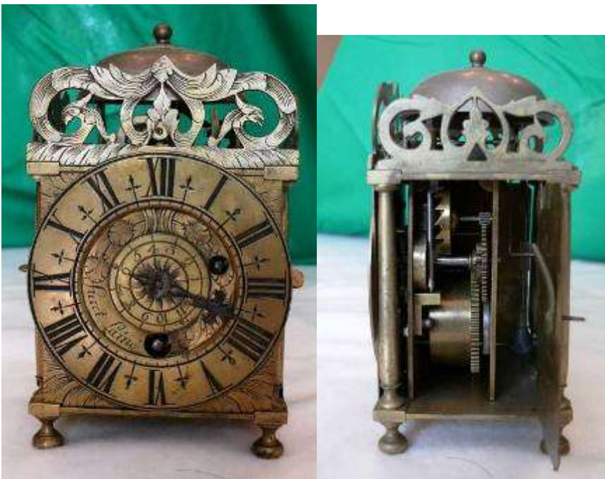
12) Orologio lanterna da tavolo , Francia "Furet Lainé" (André Furet L'ainé, Parigi circa 1691), manifattura del Seicento, scappamento a verga, due treni. Cm. 15 x 9 x 7. € xxxx,00.
