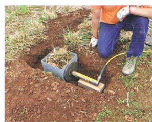
Test di resistenza a taglio in situ
