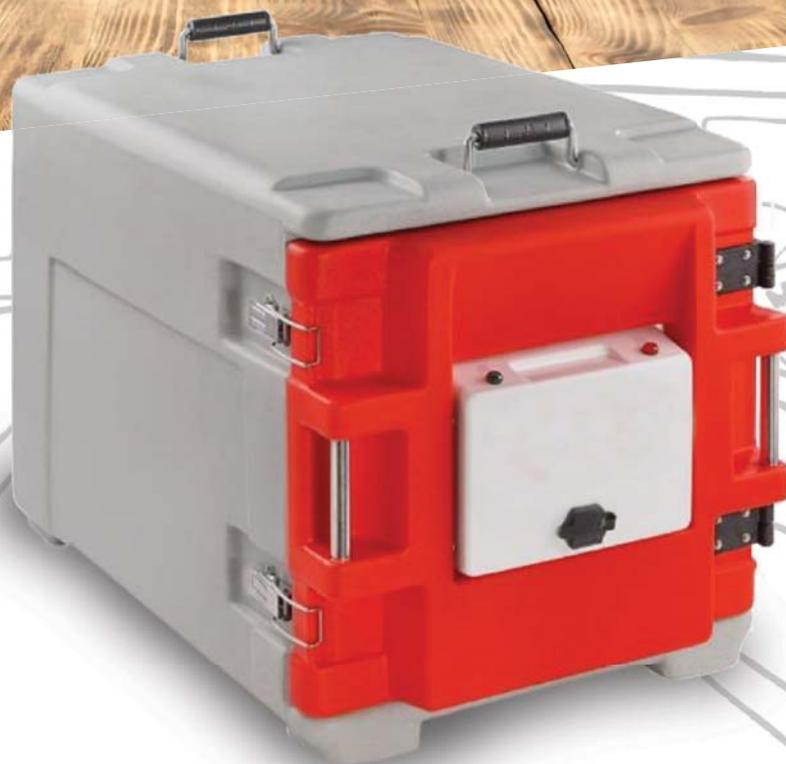
Contenitore isotermico per la **conservazione e il trasporto di alimenti caldi** realizzato in **POLIETILENE** ad uso alimentare con uno strato interno in poliuretano. L'elemento con guide presagomate interne dispone di porta di accesso con riscaldatore elettrico. Alimentato con corrente di rete o 12V (presa accendisigari).
