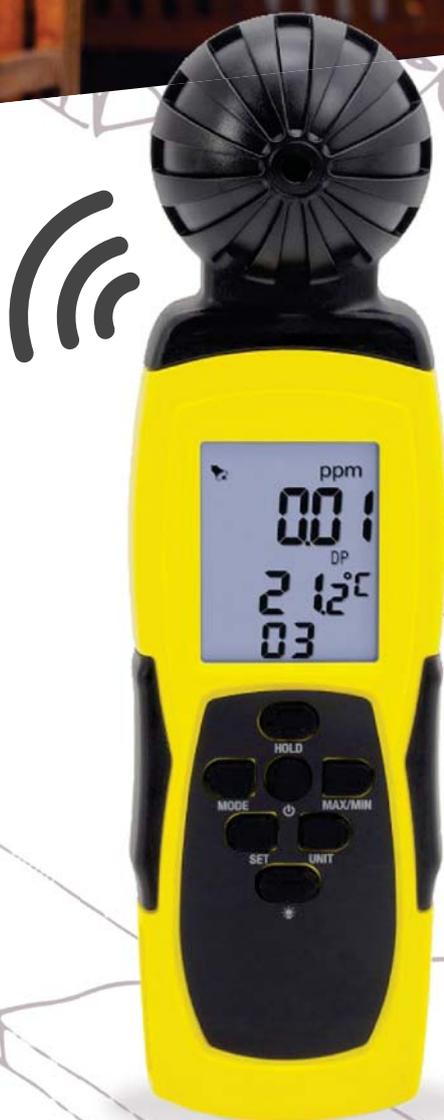
Il dispositivo OZ-ONE è un misuratore della concentrazione di ozono nell'aria. Inoltre, è possibile rilevare anche la **TEMPERATURA DELL'ARIA**, del punto di rugiada e del bulbo umido, oltre all'umidità dell'aria degli ambienti interni.
